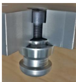
Рис. 1. Способы крепления базирующих пальцев системы SCHUNK VERO-S Aviation Fig. 1. Clamping methods of SCHUNK VERO-S Aviation system basing fingers
