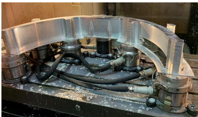
Рис. 4. Обработка контура и поверхности № 1 Fig. 4. Contour and no.1 surface machining
