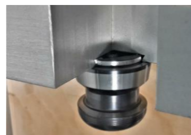
Рис. 1. Способы крепления базирующих пальцев системы SCHUNK VERO-S Aviation Fig. 1. Clamping methods of SCHUNK VERO-S Aviation system basing fingers
