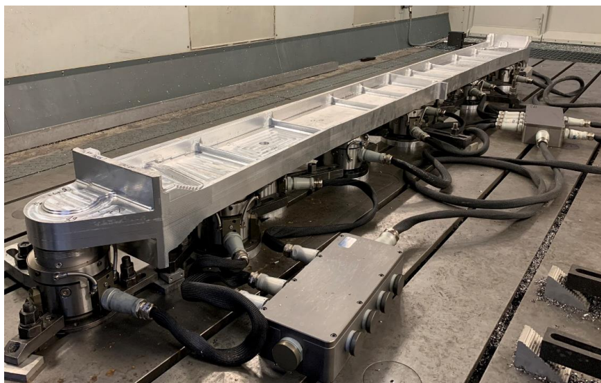
Рис. 10. Производство детали типа «Балка» с применением оснастки SCHUNK VERO-S Aviation Fig. 10. Manufacture of part rail type with using SCHUNK VERO-S Aviation system
