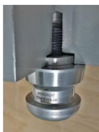
Рис. 1. Способы крепления базирующих пальцев системы SCHUNK VERO-S Aviation Fig. 1. Clamping methods of SCHUNK VERO-S Aviation system basing fingers
