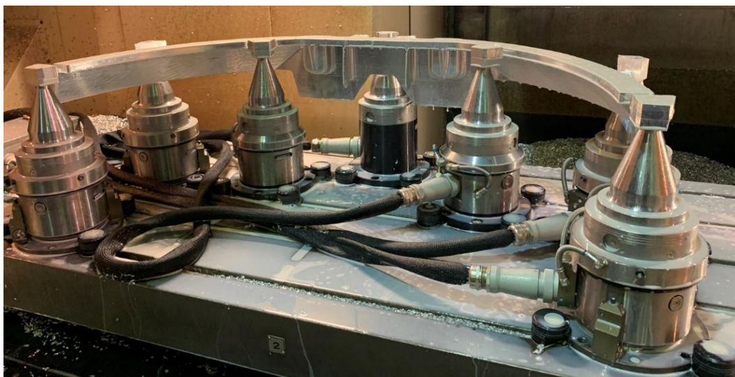
Рис. 6. Закрепление заготовки при использовании оснастки VERO-S Aviation в процессе чистовой обработки поверхности № 1 детали типа «шпангоут» Fig. 6. Workpiece clamping when using VERO-S Aviation tooling in finishing treatment of No. 1 surface of the "frame"- type part
