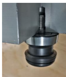
Рис. 1. Способы крепления базирующих пальцев системы SCHUNK VERO-S Aviation Fig. 1. Clamping methods of SCHUNK VERO-S Aviation system basing fingers
