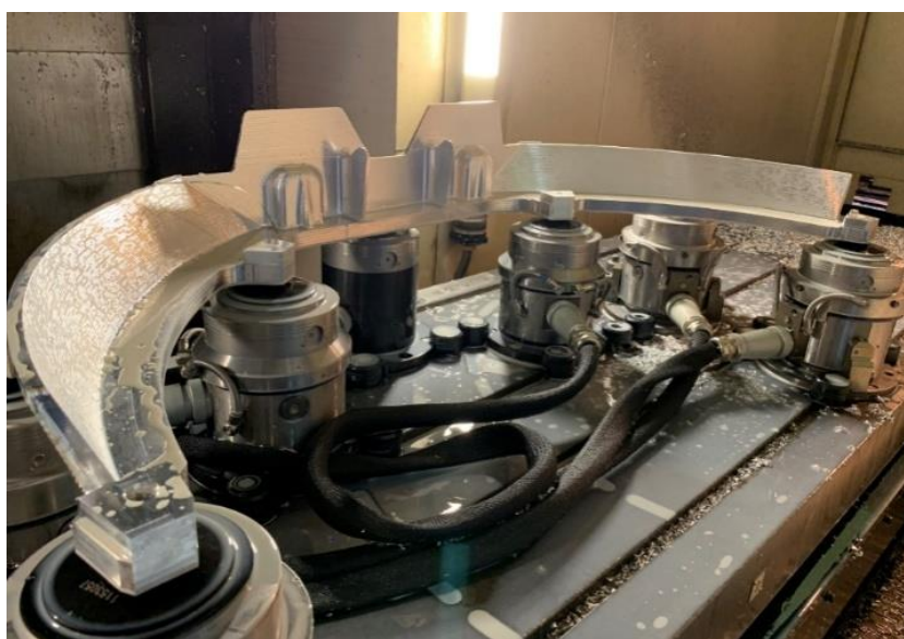
Рис. 5. Закрепление заготовки при использовании оснастки VERO-S Aviation в процессе черновой, получистовой и чистовой обработок поверхности № 2 детали типа «шпангоут» Fig. 5. Workpiece clamping when using VERO-S Aviation tooling during rough, semi-finishing and finishing treatments of the surface no. 2 of the "frame"- type part
