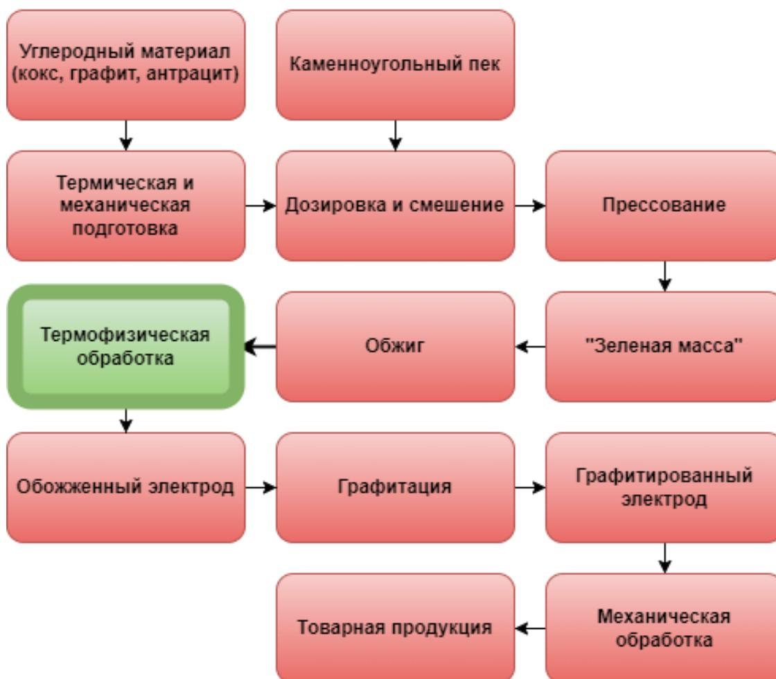
Рис. 7. Модернизированный цикл производства углеграфитовых электродов
