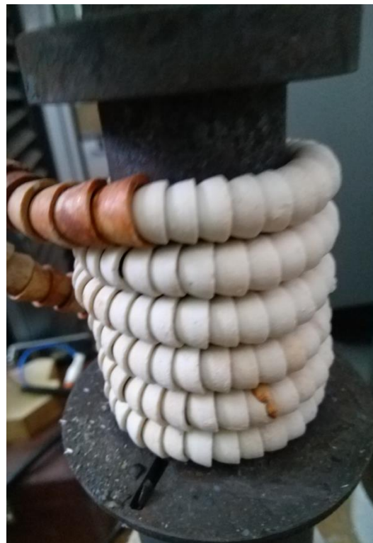
Рис. 4. Зона нагревателя на верхнем стержне установки
