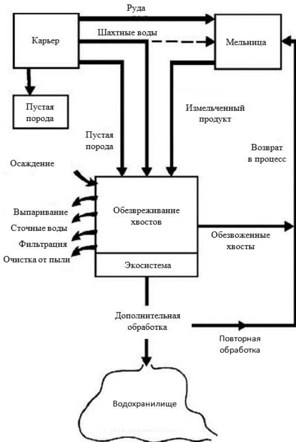
Схема водоочистки на заводе «Ecometales» (Чили) Water treatment diagram at the Ecometales plant (Chile)
