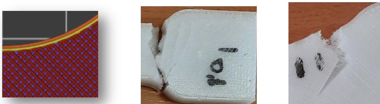
Рис. 6. Область разрушения FDM-образца, напечатанного шаблоном «линии» с заполнением 50%: а – 3d-модель нитевидной структуры; б – разрушение в зоне перехода; с – начало разрушения Fig. 6. The destruction area of the FDM sample printed with the "line" template with 50% filling: a – 3d model of the filamentary structure; b – destruction in the transition zone; c – destruction origin
