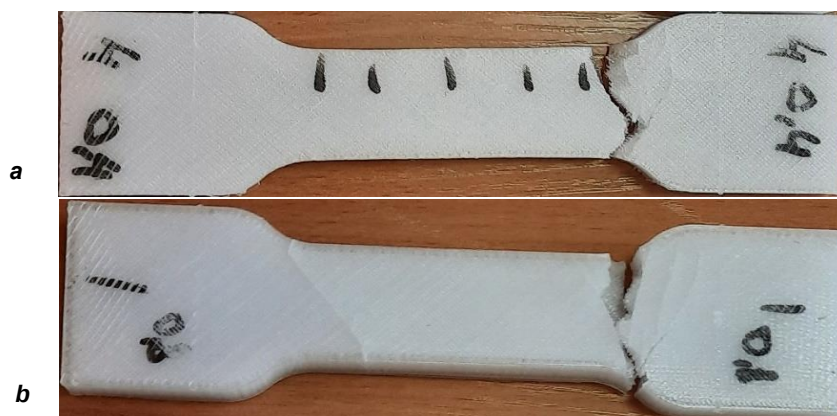
Рис. 5. Разрушенные FDM-образцы, напечатанные на 3d-принтере: а – толщина внешней оболочки 0,4 мм; б – толщина внешней оболочки 0,8 мм Fig. 5. Destroyed FDM samples printed on a 3d printer: a – outer shell thickness is 0.4 mm; b – outer shell thickness is 0.8 mm
