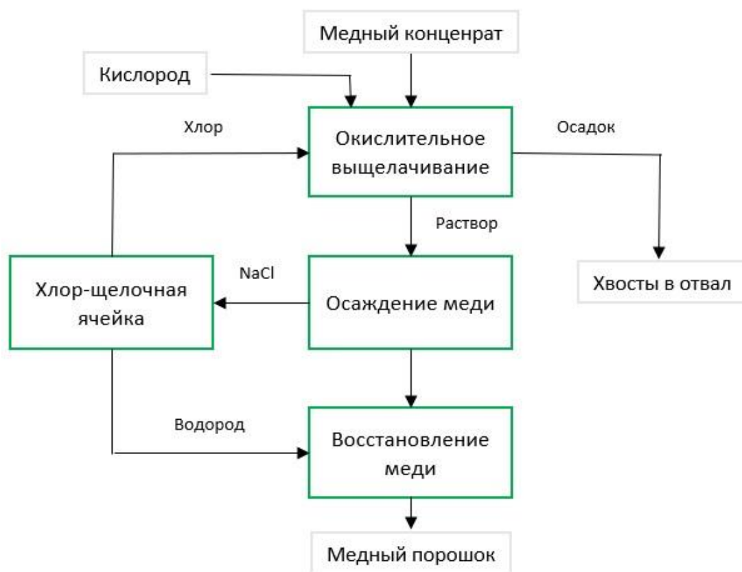
Рис. 5. Технологическая схема процесса HydroCopper Fig. 5. HydroCopper process flow diagram
