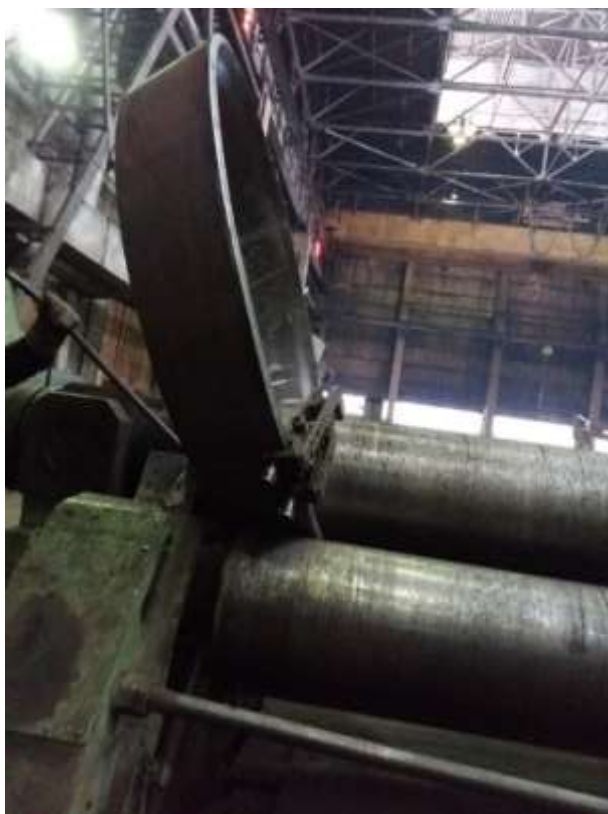
Рис. 8. Гибка конуса с использованием защитного приспособления у подшипникового узла вальцев Fig. 8. Cone bending using a protective device at the roller bearing assembly
