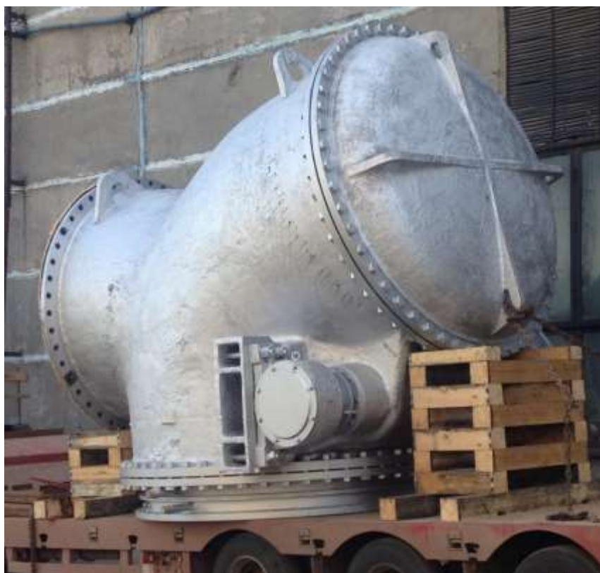
Рис. 1. Дымовой клапан Ду2000 производства Иркутского завода тяжелого машиностроения (корпус литой)
