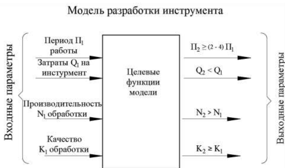
Рис. 1. Примененная модель реализации процесса имитационного проектирования инструментальных материалов
