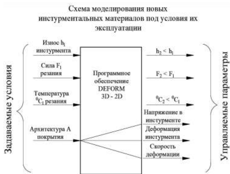
Рис. 2. Схема реализации имитационного моделирования новых инструментальных материалов Fig. 2. Implementation scheme of simulation modeling of new tool materials
