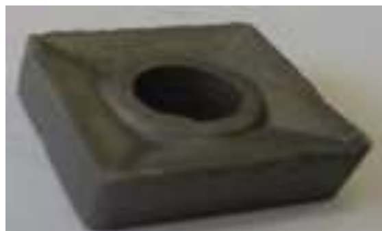
Рис. 4. Пластина квадратная, диаметр описывающей окружности 17,5 мм
