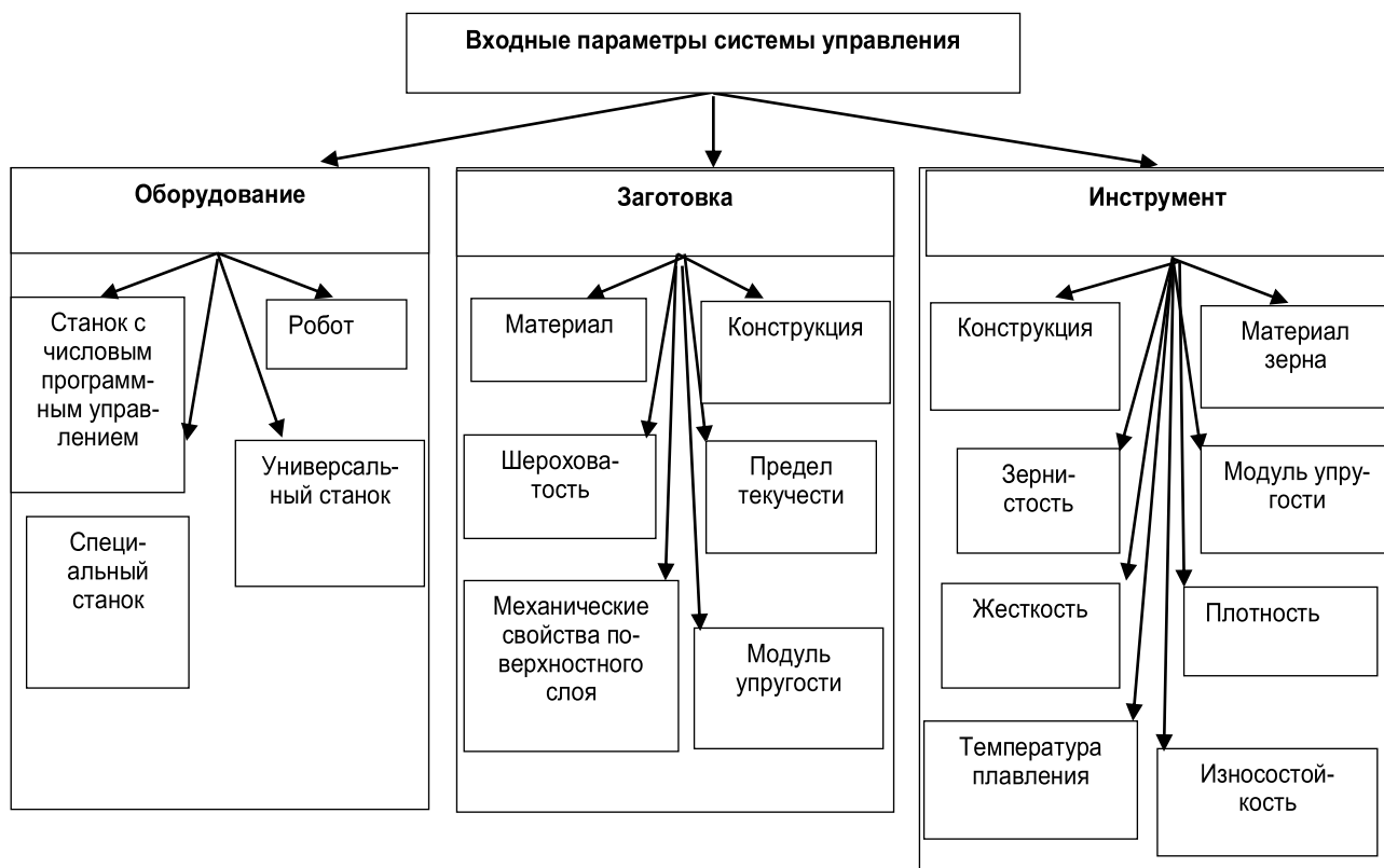
Рис. 1. Входные параметры системы управления финишной обработкой Fig. 1. Input parameters of finish machining control system
