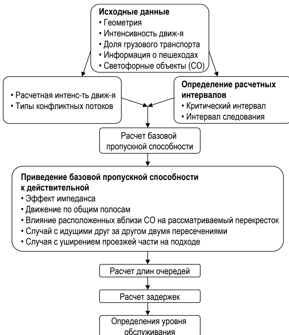
Рис. 1. Последовательность расчета пропускной способности, задержек и длины очередей на нерегулируемых и кольцевых пересечениях Fig. 1. Calculation sequence of road capacity, delays and queue length at uncontrolled intersections and roundabouts
